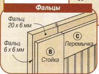
2 Соединительные узлы боковых панелей.
