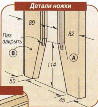
2 Соединительные узлы боковых панелей.
